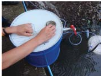
เติมน้ำลงในถังเก็บแก๊ส ปิดฝาให้แน่น
