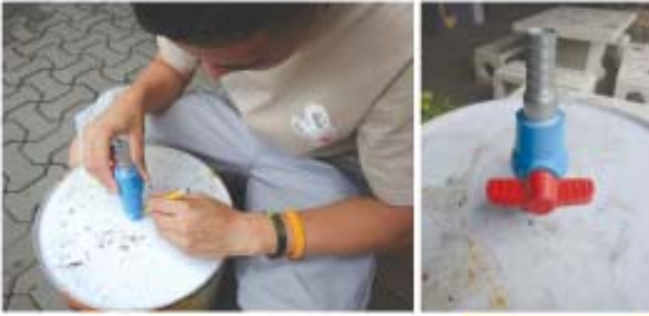
การนำบอลลูนและทางปลาใส่ในรูที่เจาะไว้ ด้วยการบิดเกลียวที่กันดั้ม
