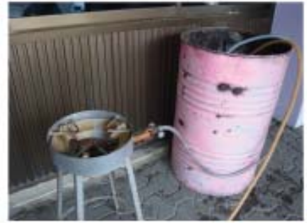
ต่อสายยางจากเตาแก๊สกับถังเก็บแก๊ส ภาพประกอบที่ 15
