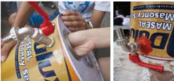
การนำก๊อมน้ำมาหมุนเกลียวให้แน่นด้านบนของถัง
