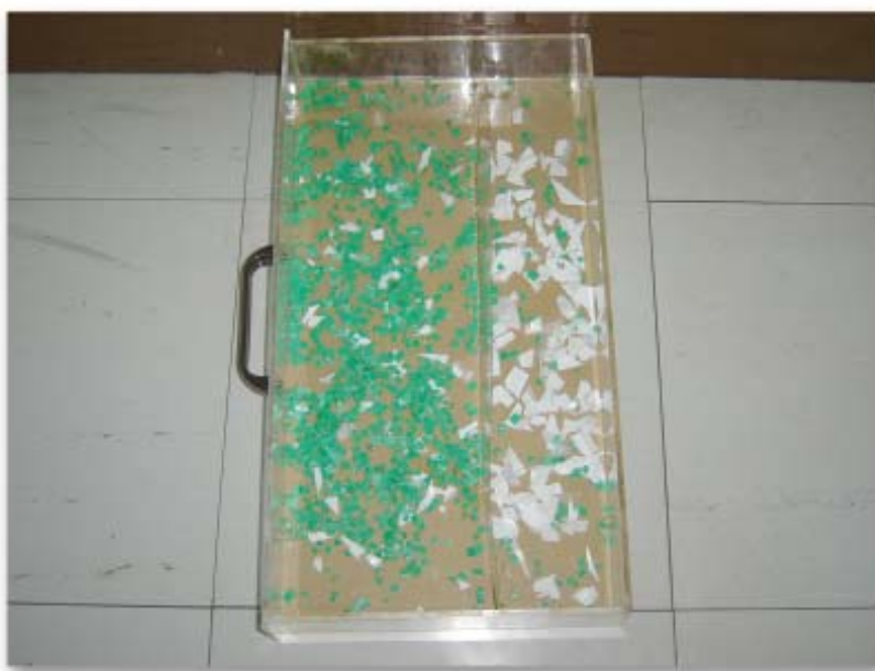
รูปที่ 3 เครื่องคัดแยกพลาสติกด้วยสนามไฟฟ้าดันแบบที่สร้างขึ้น
