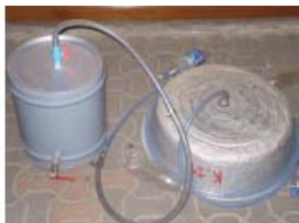
นำสายยางจากกะละมังดักแก๊ส มาต่อเข้ากับถังเก็บแก๊สชีวภาพจากแหล่งน้ำ
