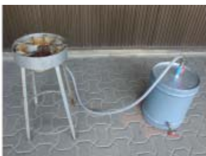
การนำแก๊สมาใช้โดยวิธีการต่อเข้ากับเตาแก๊สโดยตรง ภาพประกอบที่ 13
