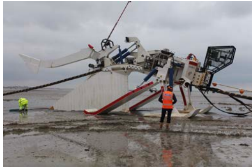
ภาพที่ 2-14 แสดงอุปกรณ์วางสายเคเบิลใต้น้ำแบบ Plough
