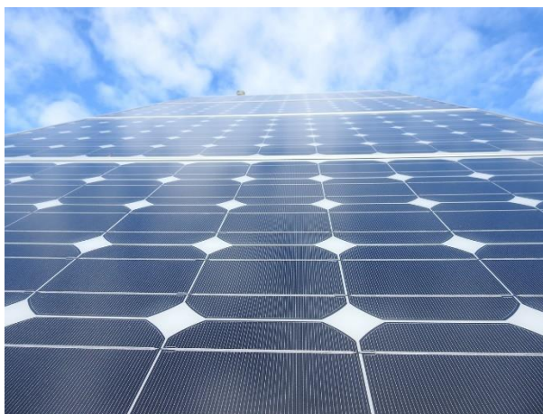
รูปที่ 1-2 แผงเซลล์แสงอาทิตย์ชนิดผลึกเดี่ยว (Monocrystalline Cells)
